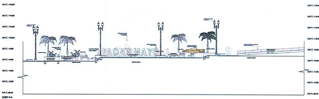
Ilustración 4: Corte de Niveles de malecón
