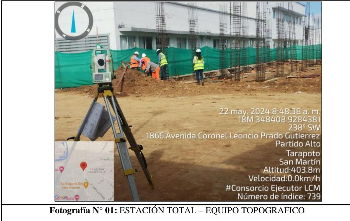
**Fotografía N° 01: ESTACIÓN TOTAL – EQUIPO TOPOGRAFICO**
