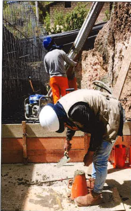
**Ilustración 08:** Se observa realizando el ensayo de cono de Abrams
